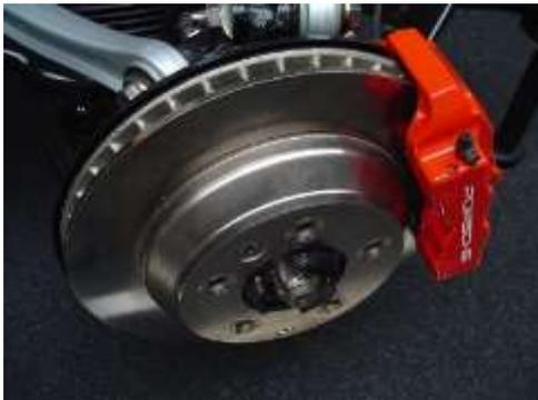
Le frein à disque est un système utilisant un disque, fixé sur le **moyeu** de la roue, et des **plaquettes**, venant frotter de chaque côté du disque.
